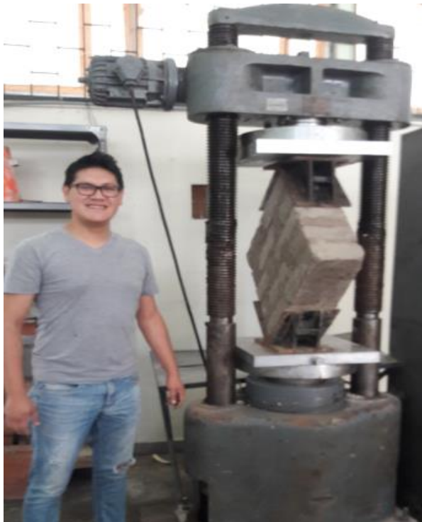
Fotografía N°08: Ensayo de murete
