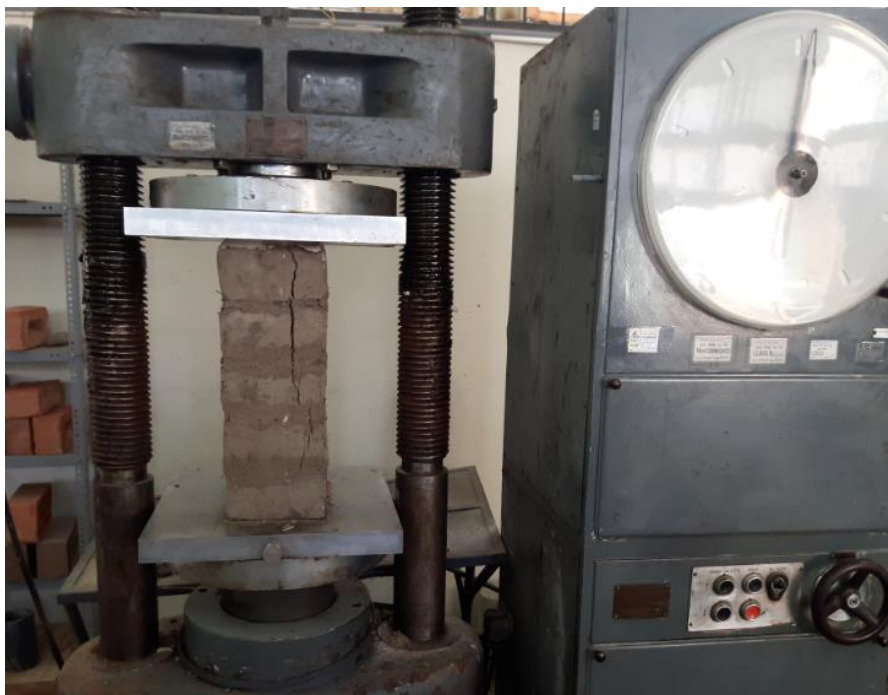
Fotografía N°10: Rotura de pila de Adobe
