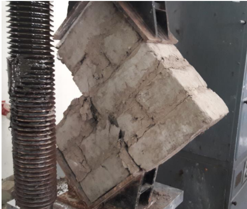
Fotografía N°11: Ensayo de muro a compresión diagonal
