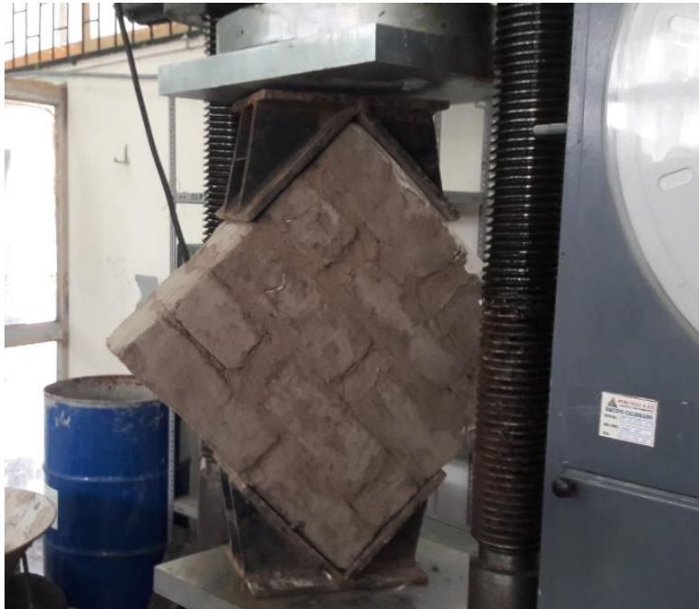
Fotografía N°07: Ensayo de Compresión de muretes de adobe
