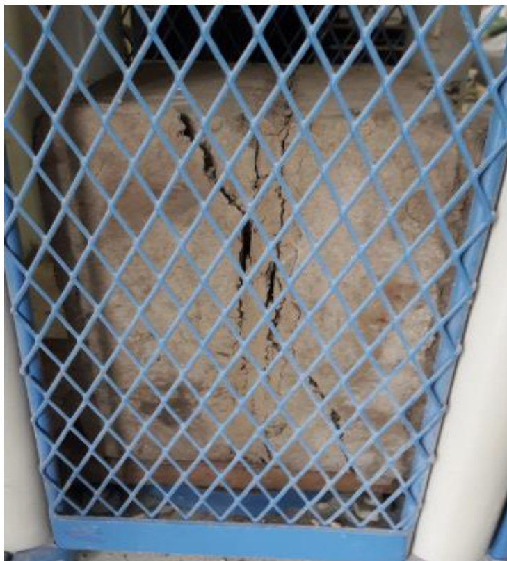
Fotografía N°12: Ensayo de resistencia del mortero a la tracción
