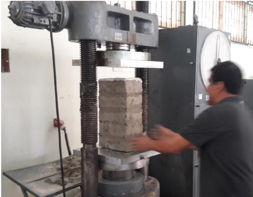
Fotografía N°09: Ensayo de pila de Adobe a compresión
